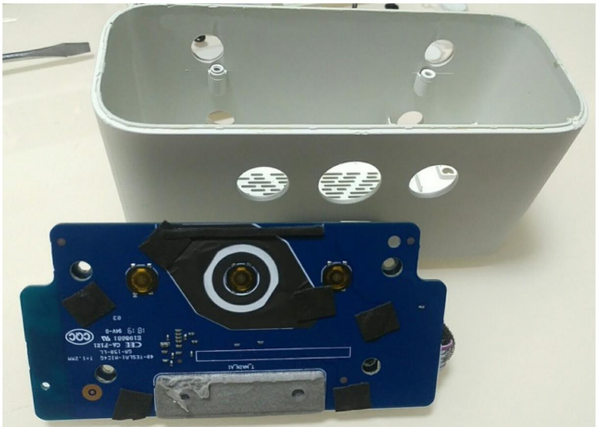
拆掉胶带，再拆螺丝：
