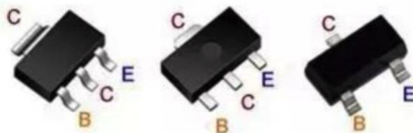
由于电流较大或散热需要，功率较大的三极管集电极引脚一般较大或面积较大，较好辨认。
