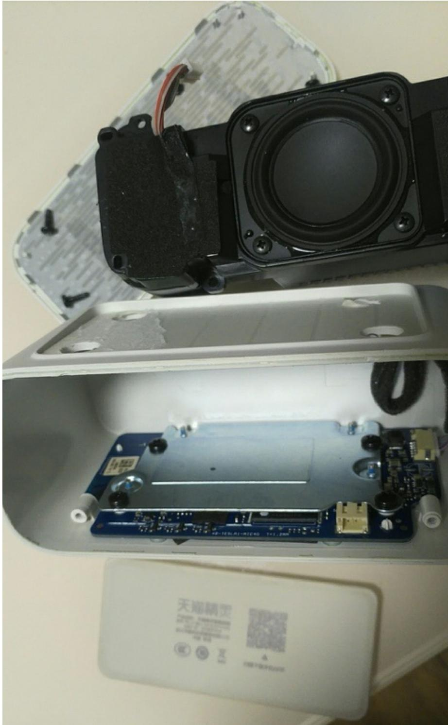
再用螺丝刀去卸电路板上的螺丝。
