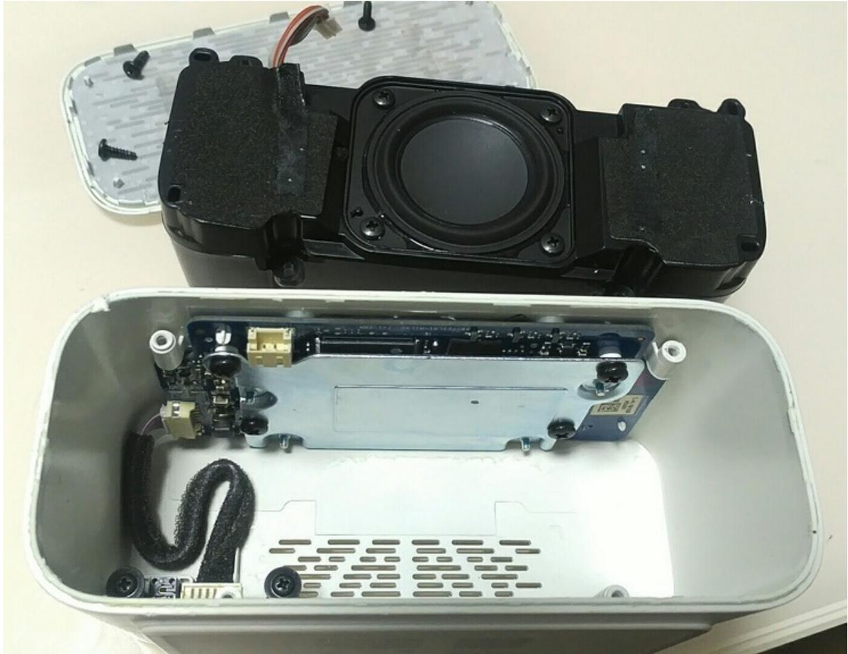
为了拆卸主电路板的螺丝，需要把说明的胶皮撕掉，漏出孔：
